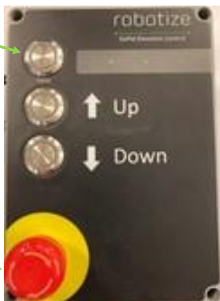
Rys. 33 Panel sterowania stacji paletowej GoPal z windą (EUW)
