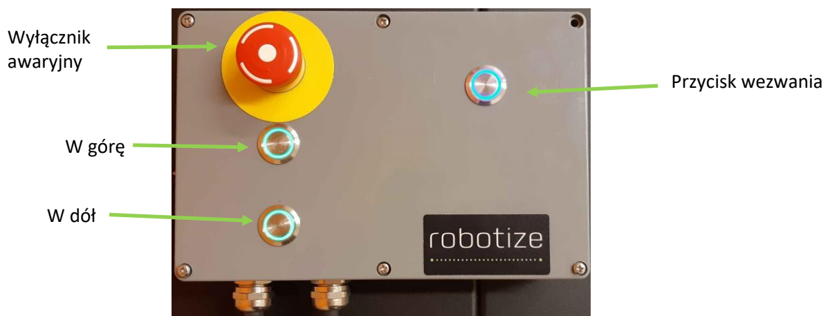
Rys. 28 Panel sterowania stacji paletowej GoPal z windą
